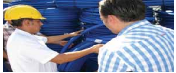
İçmesuyu borularından numune alınıp teste gönderilmesi
