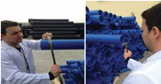
İçmesuyu borularının çap ve et kalınlık ölçümü
