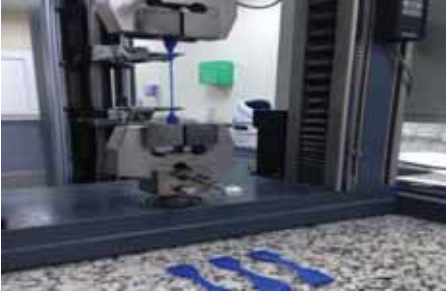
İçme suyu borularının çekme özelliklerinin tayini
