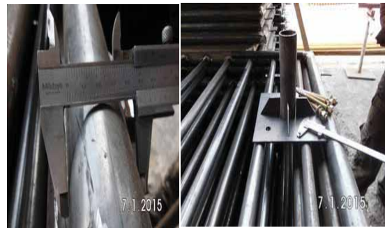
Boru profillerin dış çap ölçümü Boru profillerin imalat kontrolü
