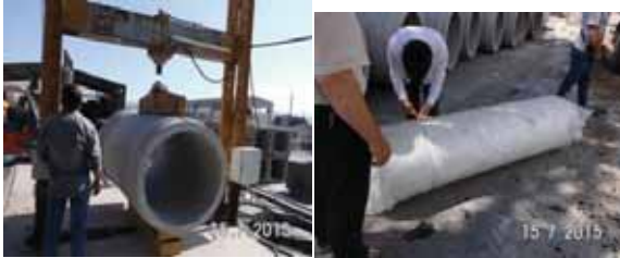
Beton boruya tepe y k  basıncı testi yapılması Alınan numunenin g nderilmek  zere hazırlanması
