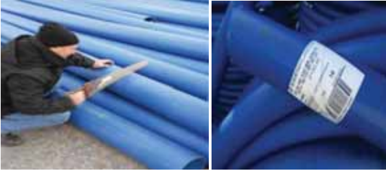
Sahaya gelen içme suyu borusundan numune alınması
