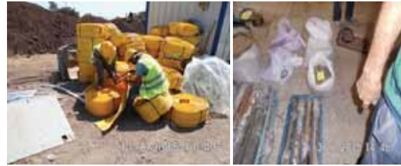
Su tutucu malzemelerden numune alınması Karot testleri için numune alınması
