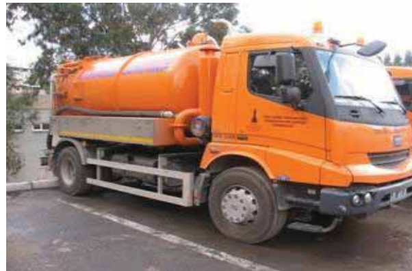
9000 litre kapasiteli blower pompalı vidanjör aracı
