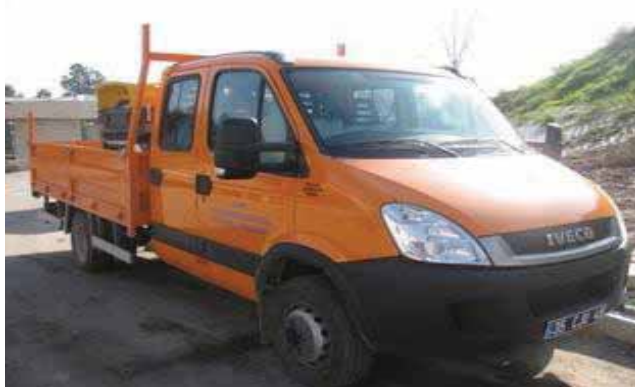
Çift kabinli kompresörlü ekip aracı
