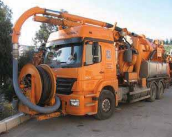
14000 m 3 emiş kapasiteli Amerikan tip kombine kanal temizleme aracı
