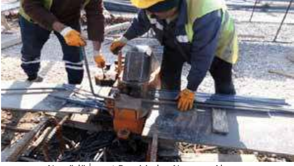
Nervürlü İnşaat Demirinden Numune Alınması
