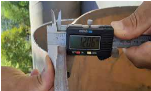
Çelik İçme Suyu ve Kılıf Boru Profillerinin Et Kalınlığı Ölçümü
