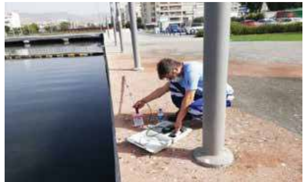
Körfez Yüzey Suyu Numune Alımı İle Yerde Oksijen ve pH Ölçümleri
