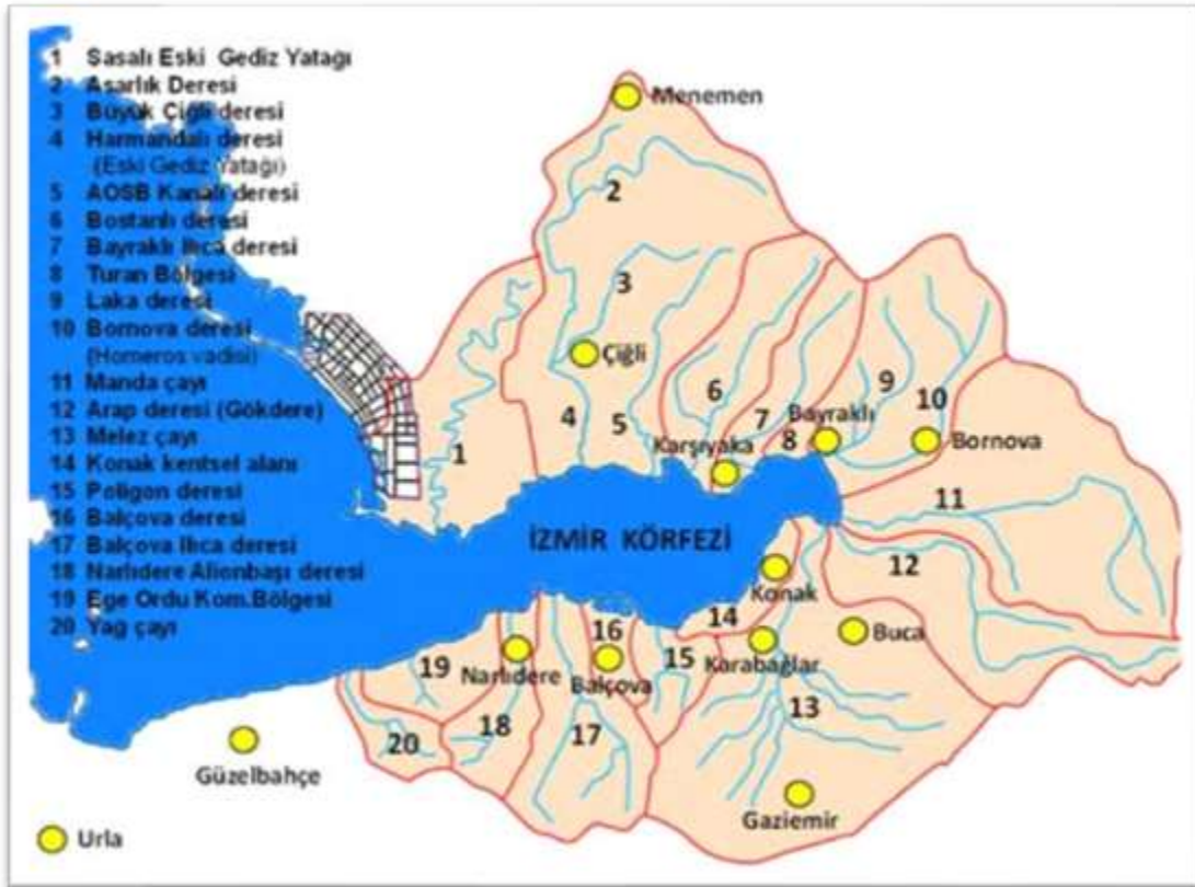
Şekil 3-7. İzmir Büyükşehir Alanı Yağmur Suyu Deşarj Sistemi
