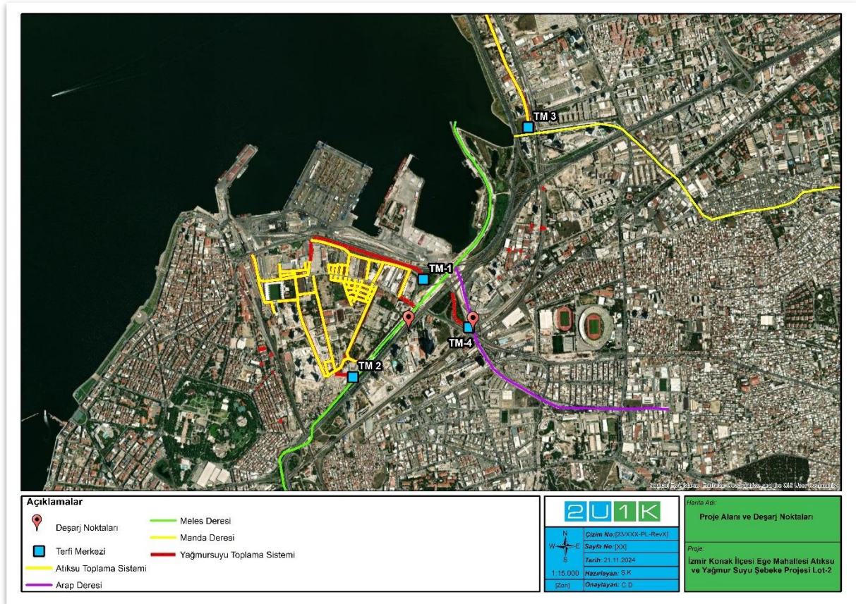
Şekil 3-1. Alt Projenin Yerleşim Planı ve Yağmur Su Deşarj Noktaları
